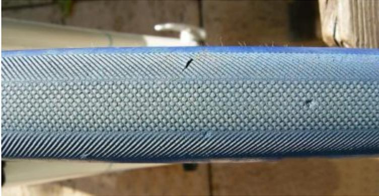
Trotz des deutlichen Verschleißes des Hinterrreifens waren bis Testende keine negativen Einflüsse im Fahrverhalten festzustellen.
