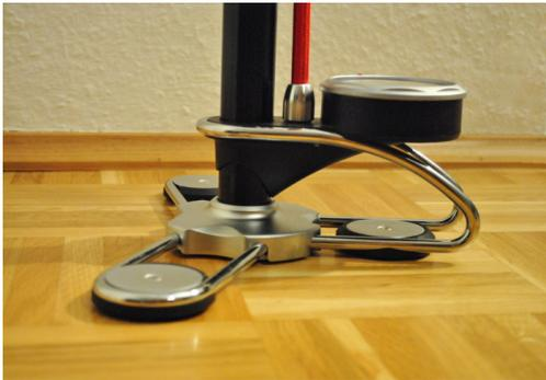
Drei leicht gewinkelte Standfüße fungieren als Basis der Pumpe. An die Basis schließt ein etwa 65 cm großer Standzylinder an (Gesamtmaß der Pumpe 75 cm). In dieser **einkolbigen Luftkammer**, welche von innen wie außen schwarz eloxiert ist, wird mittels einer Kolbenwelle die Luft komprimiert. Der zweigeteilte, **ergonomisch geformte Griff** aus materialsichtigem eloxiertem Metall (vermutlich beschichteter Stahl) schliesst den Handkompressor ab.
