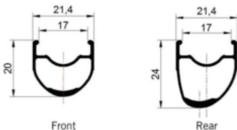
Bei der hinteren Felge setzt Vision auf ein modernes, asymmetrisches Profil, das bei hoher Steifigkeit für Antritte das Gewicht reduziert. Die vordere Felge ist symmetrisch. Eine P.E.O. Beschichtung sorgt für widerstandsfähige Bremsflanken und schnelle Verzögerung. Insgesamt bleibt die Waage letztendlich bei nur 1380g stehen!
