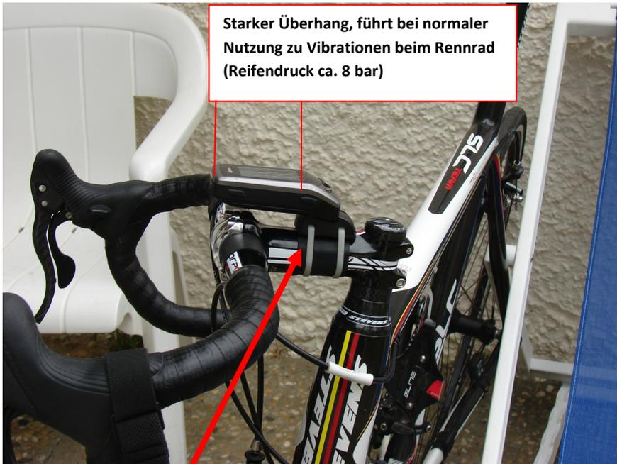
Einbausituation an meinem Lenkervorbau. Das mitgelieferte **Gummiband wurde** von mir **doppelt aufgeklebt** um Vibrationen zu dämpfen!
