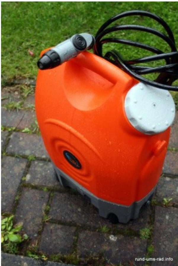
Der Hochdruckreiniger ist schnell zusammengebaut. Vormontiert ist das Gerät bereits von Werk aus, einzig der Schlauch und die Enddüse müssen aufgesetzt werden. Das geht alles in Windeseile. Nachdem der Easywasher dann mit einem Netzteil aufgeladen wurde, kann es schon an das Befüllen des Wassertanks gehen.
