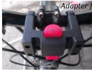
*Adapter fertig montiert*
