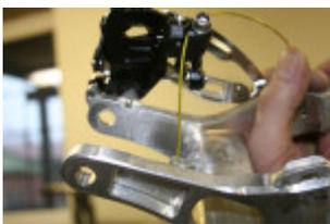
Bild mit Umwerfer welches zeigt, wie die erste Kettenstrebe nach dem Verschweißen auf Funktionalität mit den Umwerfern funktioniert
