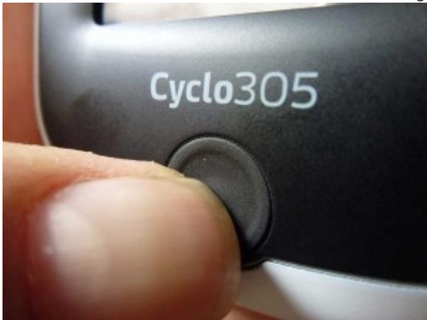
Auch das Cyclo 305 soll Wasserdicht sein, also nach der Schutzart IPX7 (Schutz gegen Wassereindringung bei zeitweisem Eintauchen)
