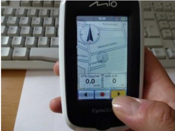
Einzig die Taste zum Ein- und Ausschalten sollte einen etwas markanteren Druckpunkt haben. Wenn man mit dem Fingernagel darüber fährt, kann man zwar den kleinen Taster in der Mitte spüren, drückt man aber mit dem Daumen drauf, so fehlt hier einfach das Gefühl und man drückt automatisch stärker drauf, obwohl es nicht nötig ist.
