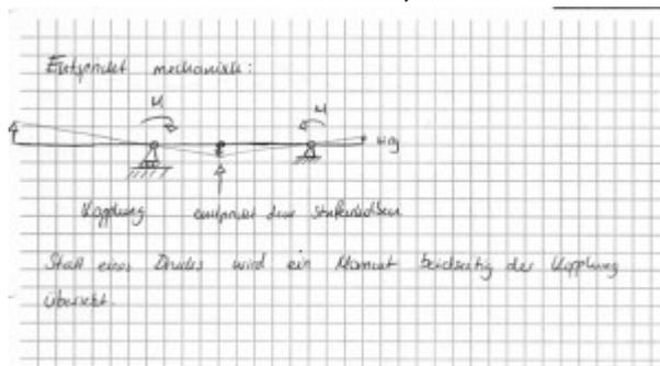
Bei einem mechanischen **Hebel**, genau wie bei einer hydraulischen Übersetzung handelt es sich rein technisch um eine Art Kraft-Weg übersetzendes **Getriebe**.
