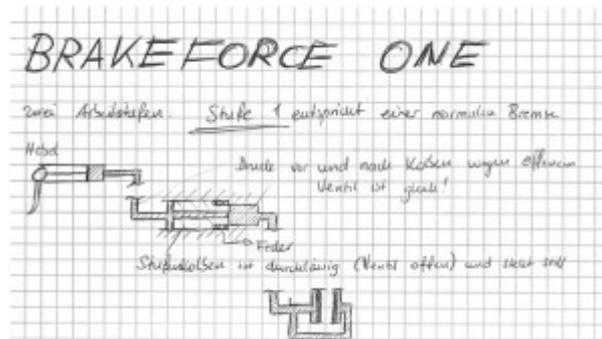
Bevor ihr den Hebel anfasst und bewegt habt, ist das Ventil im Stufenkolben offen, sodass die Bremsflüssigkeit durch ihn hindurchgehen kann. Er ist in dieser Phase funktional nicht mehr als ein Stück Leitung.
