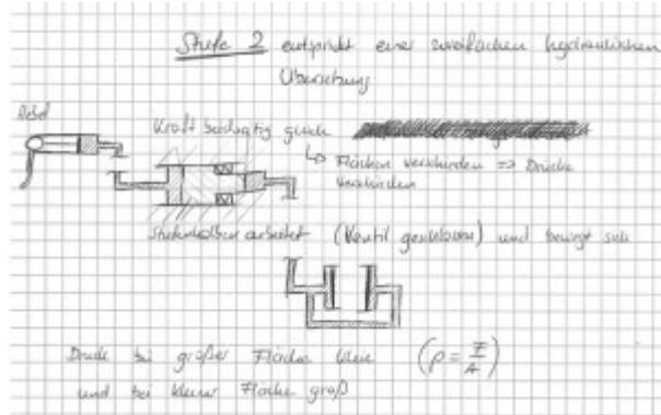
Eine Übersetzung der Kraft erfolgt hier also doppelt - einmal zwischen Geberkolben und Stufenkolben und dann wiederum zwischen Stufenkolben und **Nehmerkolben**. Mechanisch gleichwertig wäre in dieser Phase besagtes, in Reihe geschaltetes Hebelpaar, während eine konventionelle Bremse einem einfachen Hebel entspräche.
