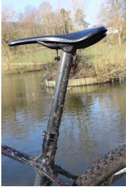
Die Optik und Verarbeitungsqualität der Parts ist auf hohem Niveau und sie wiegen fast nichts. Insgesamt lassen sich mit den drei Anbauteilen im Schnitt etwa 300g gegenüber den in Serienbikes verbauten einsparen. Darüber hinaus bietet die Sattelstütze einen sehr hohen Komfort. Beim sitzenden Pedalieren über Unebenheiten gibt sie Stöße etwas gedämpfter an den Fahrer weiter als bisher getestete Sattelstützen.
