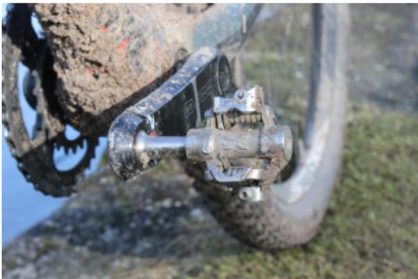
Eine 3-fach Cartridge Lagerung soll gemäß des Herstellers für eine hohe Langlebigkeit sorgen. Mittlerweile wurde das Testpedal mehr als acht Monate lang getreten und über schlammige Trails geschickt. Das rechte Pedal läuft noch wie am ersten Tag und das linke Pedal weist nur sehr leichtes Spiel auf. Die Haltbarkeit ist somit wirklich gut, bisher ohne Abstriche gegenüber des Platzhirschs Shimano.
