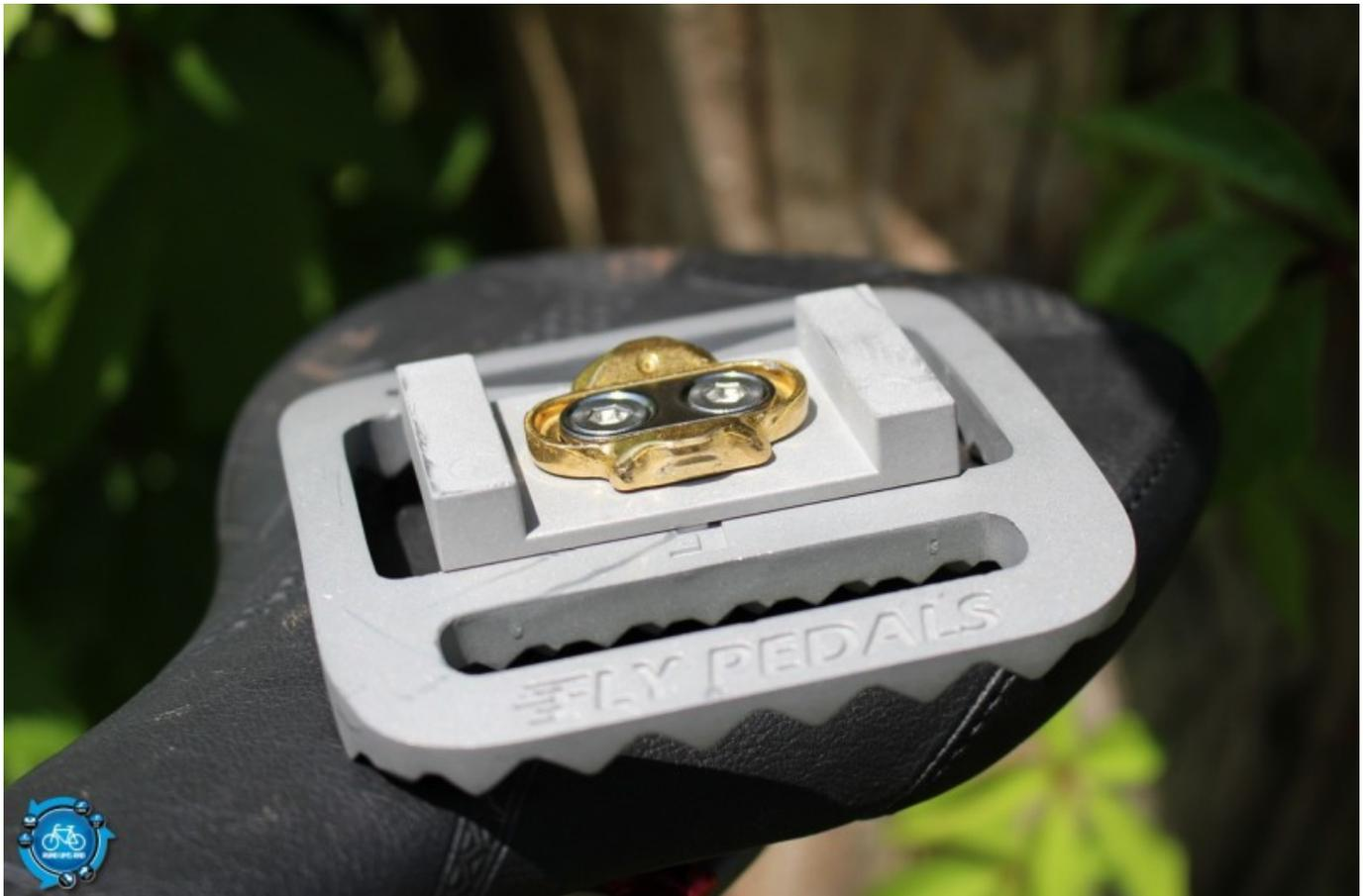
Cleat am Fly Pedal montiert
