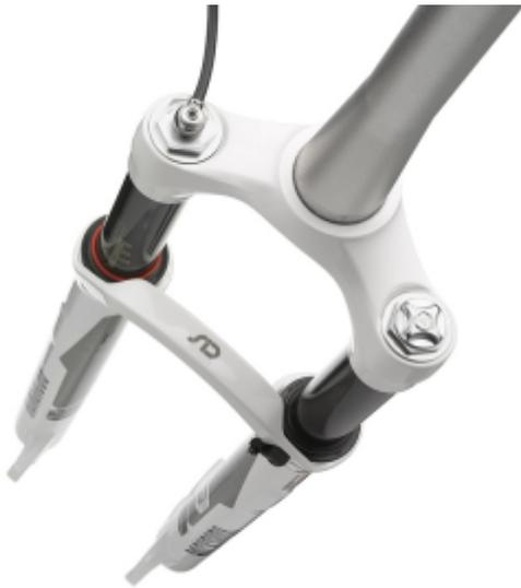
Ebenfalls neu sind die nun schwarz anodisierten Standrohre. Optisch wohl Geschmacksache aber uns gefällt´s. Weiterhin sind sie mit einer SAG Skala versehen, die es deutlich vereinfacht das Setup und den passenden Luftdruck zu finden.
