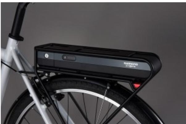
Der Akku des STePS Systems besitzt eine Kapazität von 418 Wh und lässt sich in nur vier Stunden vollständig aufladen. Bezüglich der Montage stehen zwei Akku-Versionen zur Verfügung: eine zur klassischen Gepäckträgermontage und eine für die Unterrohrposition. Die Lebensdauer der Akku liegt bei 1.000 Ladezyklen, nach denen der Akku noch immer auf mehr als 250 Wh geladen werden kann.
