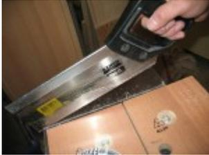
Nach dem Sägen, egal mit was, sind die Sägekanten noch rau und müssen erst einmal geschliffen werden.
