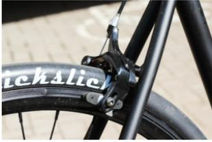
Tektro Felgenbremsen sorgen für die Verzögerung. Wer will, kann mit ihnen problemlos das Hinterrad zum Blockieren bringen und auch sonst kommt man immer sicher zum Stehen.
