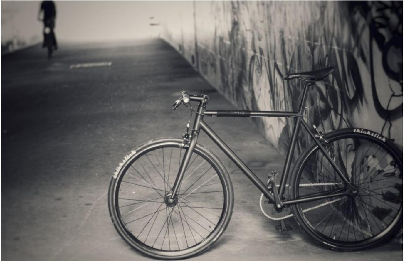
Wer es ganz puristisch mag, hat beim Floater die Möglichkeit das Hinterrad umzudrehen und mit einem starren Gang zu fahren. Die Flip-Flop Nabe bietet im Gegensatz zu normalen Naben je rechts und links von den Speichen ein Ritzel. Das eine ist mit einem Freilauf verbunden und das andere starr, sprich fixed. Solange sich die Räder drehen, drehen sich auch die Pedale. Wer ungeübt ist und aufhört zu treten, wird wie beim Bullriding einfach abgeworfen.
